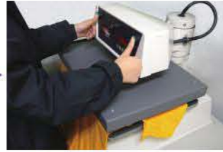
②機械の設定は、温度150~160度で、中圧、15~20秒のプレスをします。
